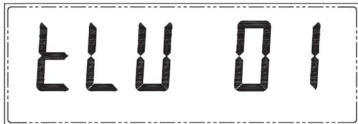
Una vez seleccionada la posición de memoria que deseamos memorizar, pulsar la tecla y aparecerá un numero en el display. Para modificarlo e introducir el valor de la tara, con los cursores superior e inferior seleccionar el dígito deseado. Para pasar al dígito de la derecha, pulsar la tecla y modificarlo con los cursores y .
