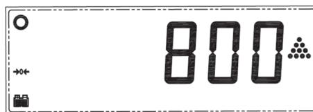
Colocar las piezas a contar (deben ser del mismo peso unitario que la muestra anterior) en el plato de pesada. Puede contarse dentro de un recipiente, previa efectuada la tara (consultar apartado Uso de la Tara).
